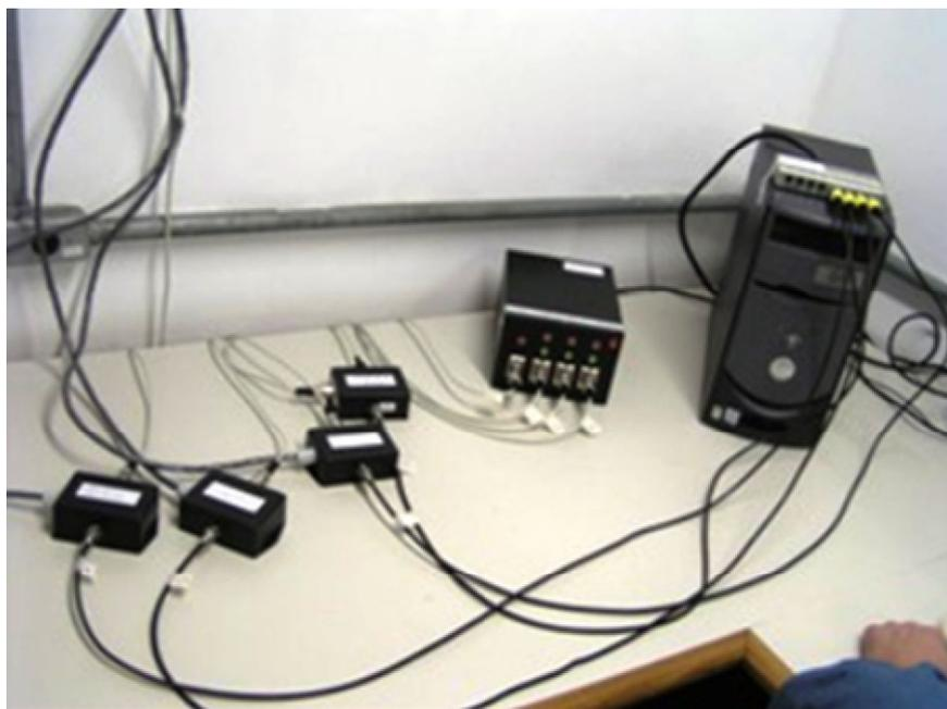
**Figura 4.14:** Parte do sistema de cabos, pré-amplificadores, fonte, computador e da placa de som Delta44 do sistema de aquisição de dados da estação de recepção SAVNET do Observatório Espacial do Sul, em São Martinho da Serra, RS.
